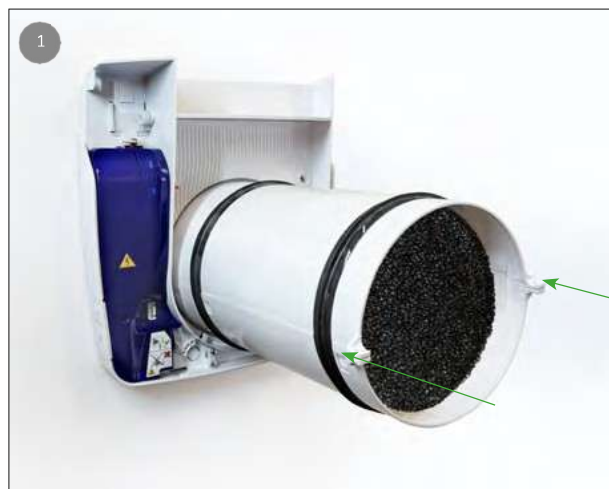
Vložte centrální těleso do kanálu tak, aby kabel ventilátoru směřoval dolů a 2 úchyty (pravý a levý) byly vycentrovány, jak je vidět na obrázku. Zkontrolujte správné umístění těsnění.
