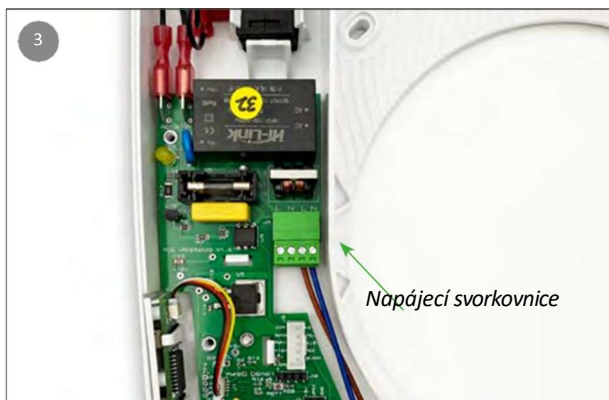
Sejměte poloprůhledný kryt, který je upevněn pomocí šroubu.
